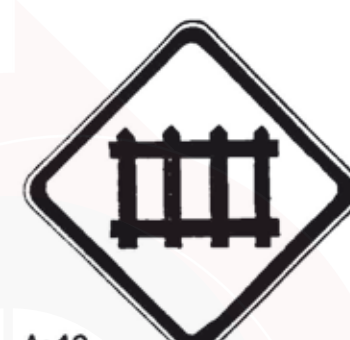
A-40 PASSAGEM DE NÍVEL COM BARREIRA
