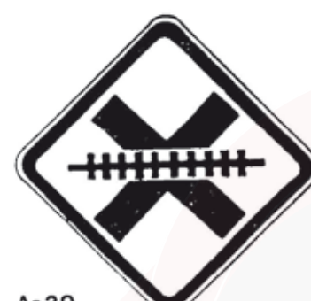
A-39 PASSAGEM DE NÍVEL SEM BARREIRA
