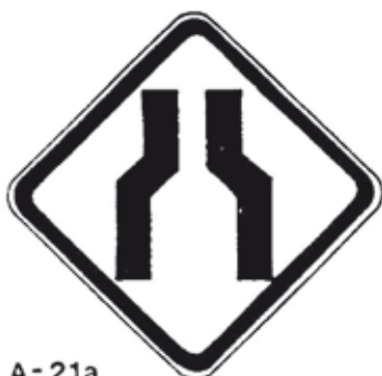
A-21a ESTREITAMENTO DE PISTA AO CENTRO
